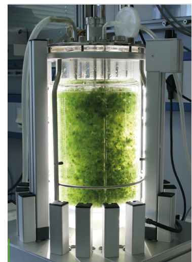
Torfmoosvermehrung im Bioreaktor zur Ausbringung auf Paludikulturflächen. Foto: Melanie Heck/ Universität Freiburg
