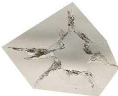
Abb. 2. Beispiele von Rissbildungen in Gelatine
