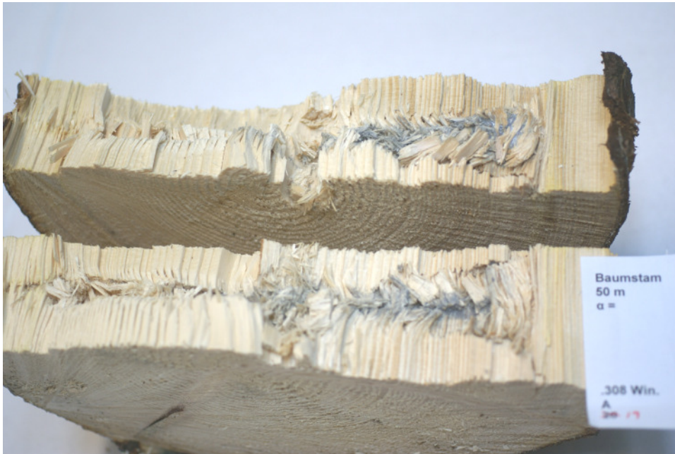
Auftreffwinkel 90° Das Geschoss „A“ hinterließ einen deutlichen Bleiabrieb im Holz.
