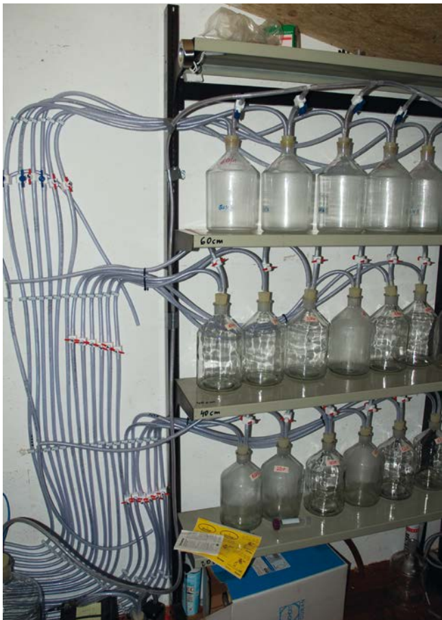
Abbildung 9: Sickerwasserproben aus verschiedenen Bodentiefen
