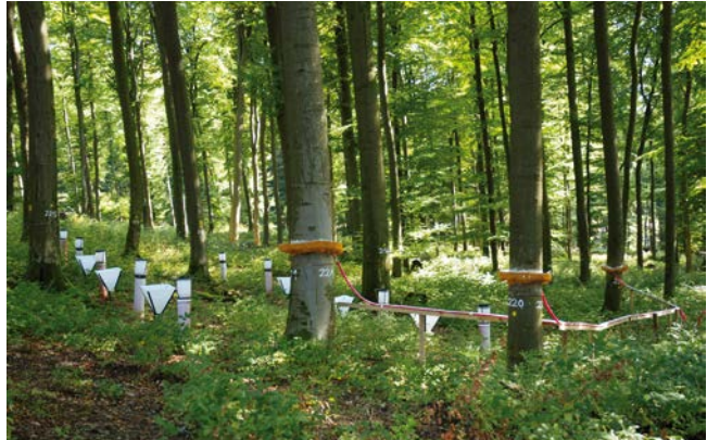
Abbildung 6: Beobachtungsfläche des intensiven forstlichen Umweltmonitorings mit Streufallsammlern, Depositionssammlern und Sammler für den Stammablauf
